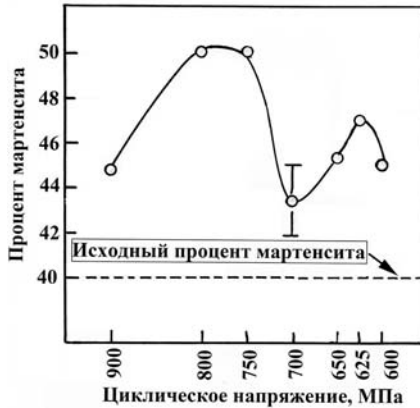
Рис. 2. Изменение содержания мартенсита в зависимости от циклического напряжения; при напряжении 700 МПа экспериментальная точка определялась по двум образцам.
