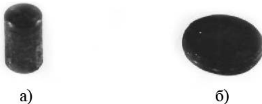
Рисунок 1. – Образцы из стали Р6М5 в исходном состоянии (а) и после нагрева и изотермического сжатия (б) в изотермических условиях.
