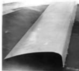
Рис.1.Элементы конструкции из Алор D16/41 а) нервюра носка крыла; б) обшивка носка крыла
