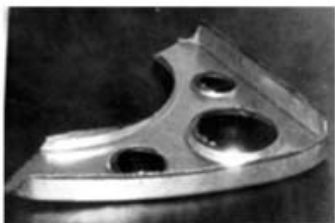
Рис.1.Элементы конструкции из Алор D16/41 а) нервюра носка крыла; б) обшивка носка крыла
