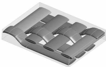
Рисунок 1 – Геометрические модели представительных элементов объема волокнистых УКМ с различной схемой армирования: а – слой ткани сатинового плетения; б – слой ткани полотняного плетения
