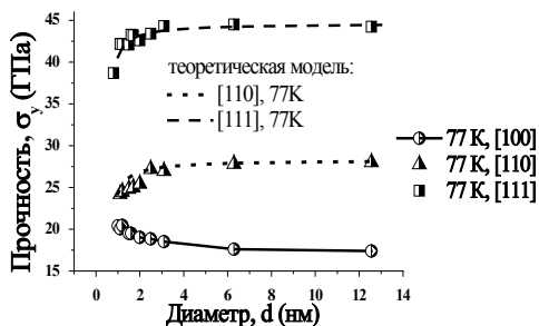
Рис. 1. Зависимость «прочность-диаметр» образцов нанокристаллов Мо в условиях одноосного растяжения в направлении [100], [110], [111] при T = 77К.
