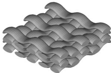
Рисунок 1 – Геометрические модели представительных элементов объема волокнистых УКМ с различной схемой армирования: а – слой ткани сатинового плетения; б – слой ткани полотняного плетения
