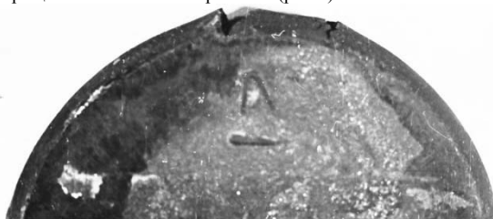
Рисунок 2 – Трещина на боковой поверхности образца (вид сверху) после изотермического сжатия.
