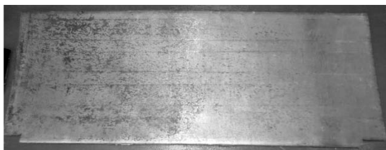
Рисунок 1 – Лист термобиметалла 36Н+Л63 размером 6х300х800 мм
