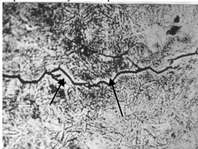
Рис. 3. Разрушение арматурной стали 23Х2Г2Ц после катодного насыщения в течение 27 час. \times 600
